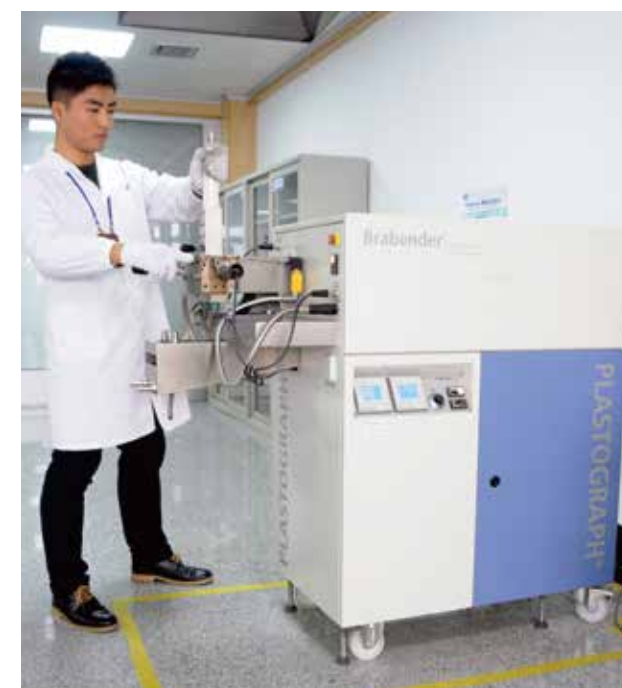
BRABENDER TORQUE RHEOMETER
